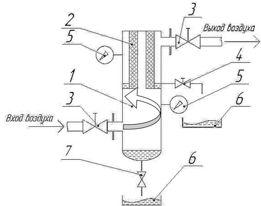
**Рисунок 3. Схема подсоединения магистрального фильтра в пневмосеть.**
