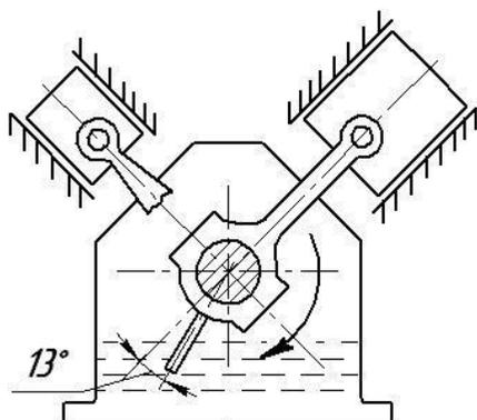
Разбрызгиватель при вращении коленчатого вала должен «гладить» поверхность масла
