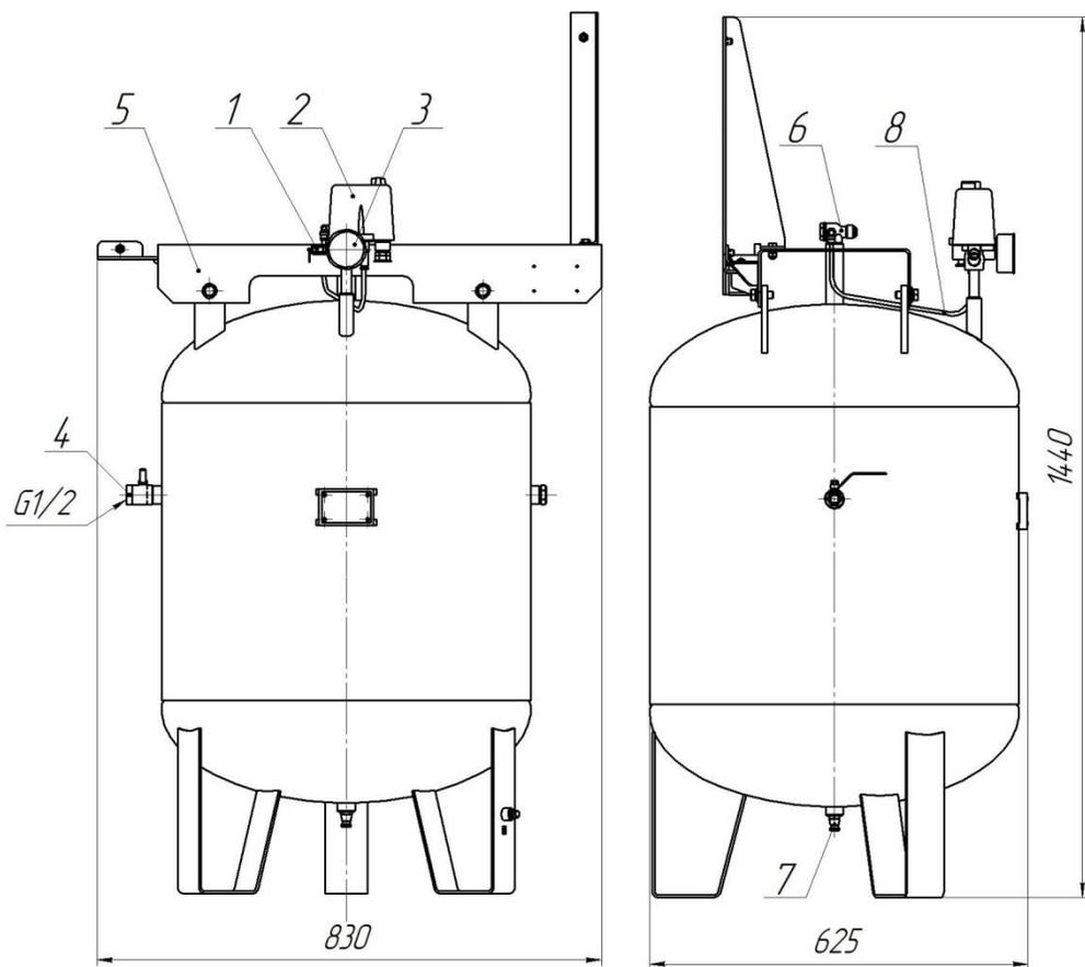
**Рис.14 Резервуар установки компрессорной,
