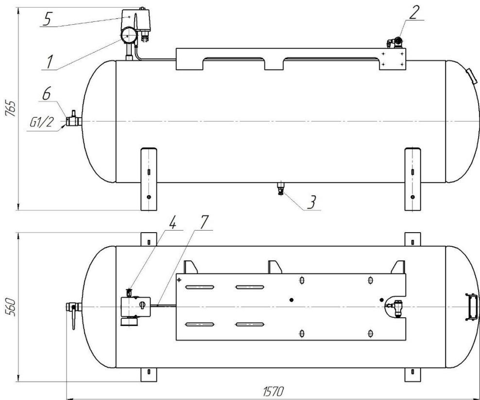
**Рис.13** Резервуар установки компрессорной, модель K22M:
