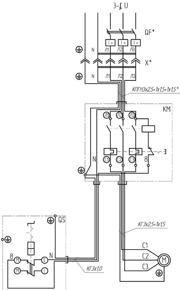
**Рис.25** Схема электрическая принципиальная и соединений установки компрессорной моделей K31, K31-01
