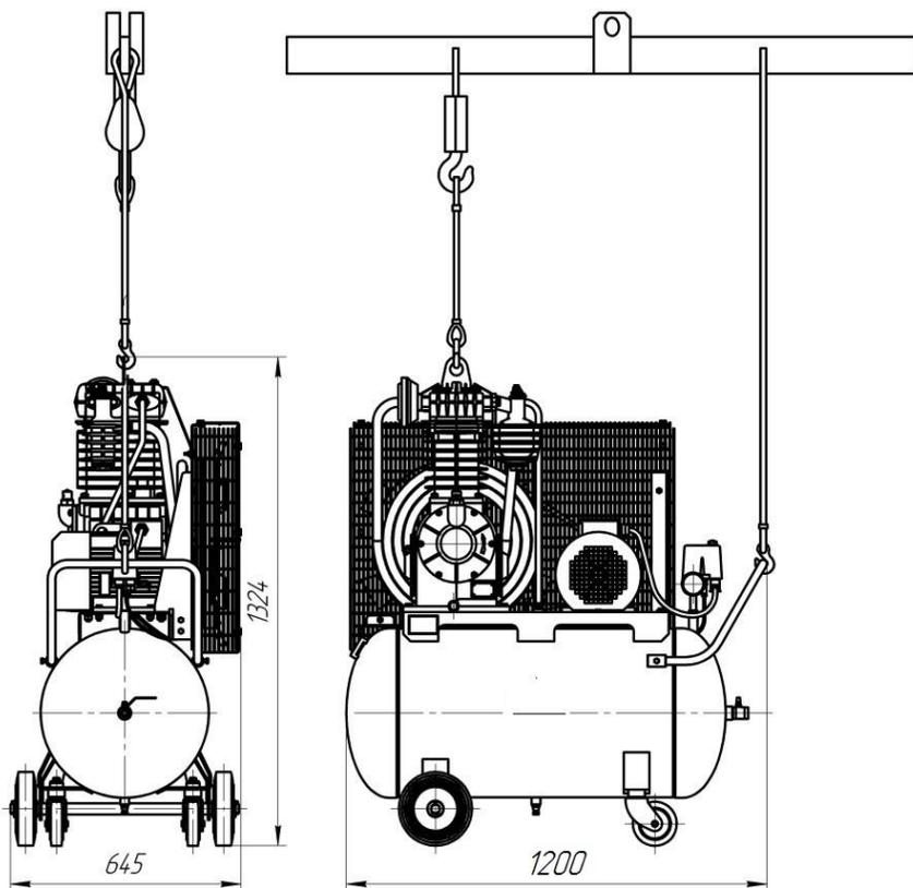
**Рис.28** Схема строповки установки компрессорной
