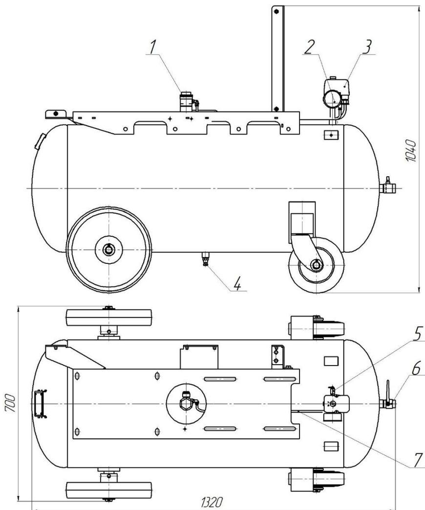
**Рис.12 Ресивер установки компрессорной,
