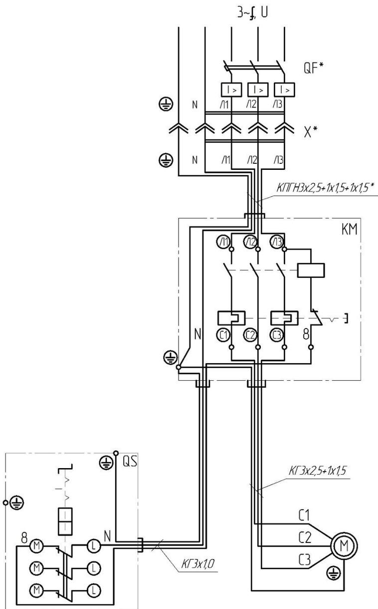
**Рис.26** Схема электрическая принципиальная и соединений установки компрессорной, модель **K31-02**
