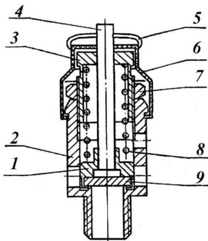
**Рис.18 Клапан предохранительный:**
