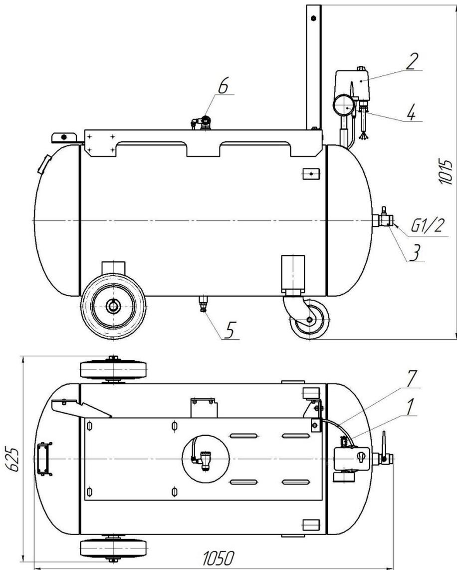
**Рис.11** Ресивер установки компрессорной
