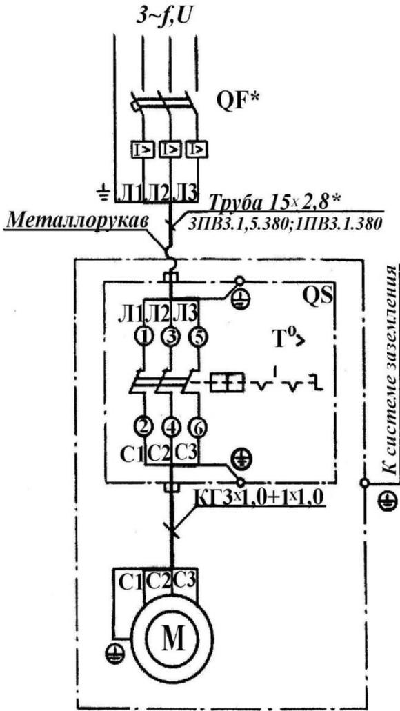
Рис.22 Схема электрическая принципиальная и соединений установки компрессорной моделей KB15, KB15-01, KB15-02
