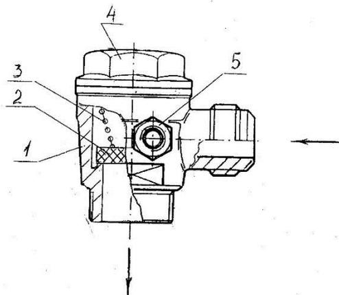
**Рис.17 Обратный клапан**
