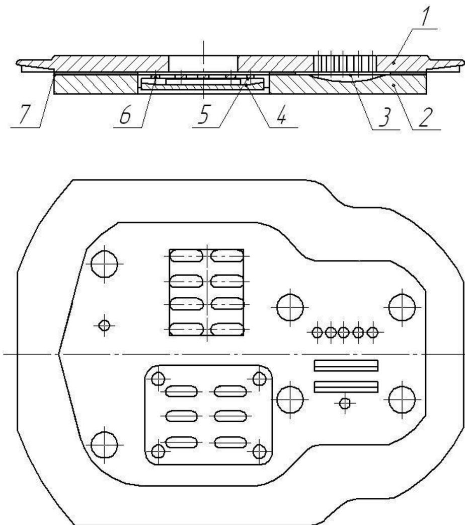
**Рис.10 Блок клапанный:**
