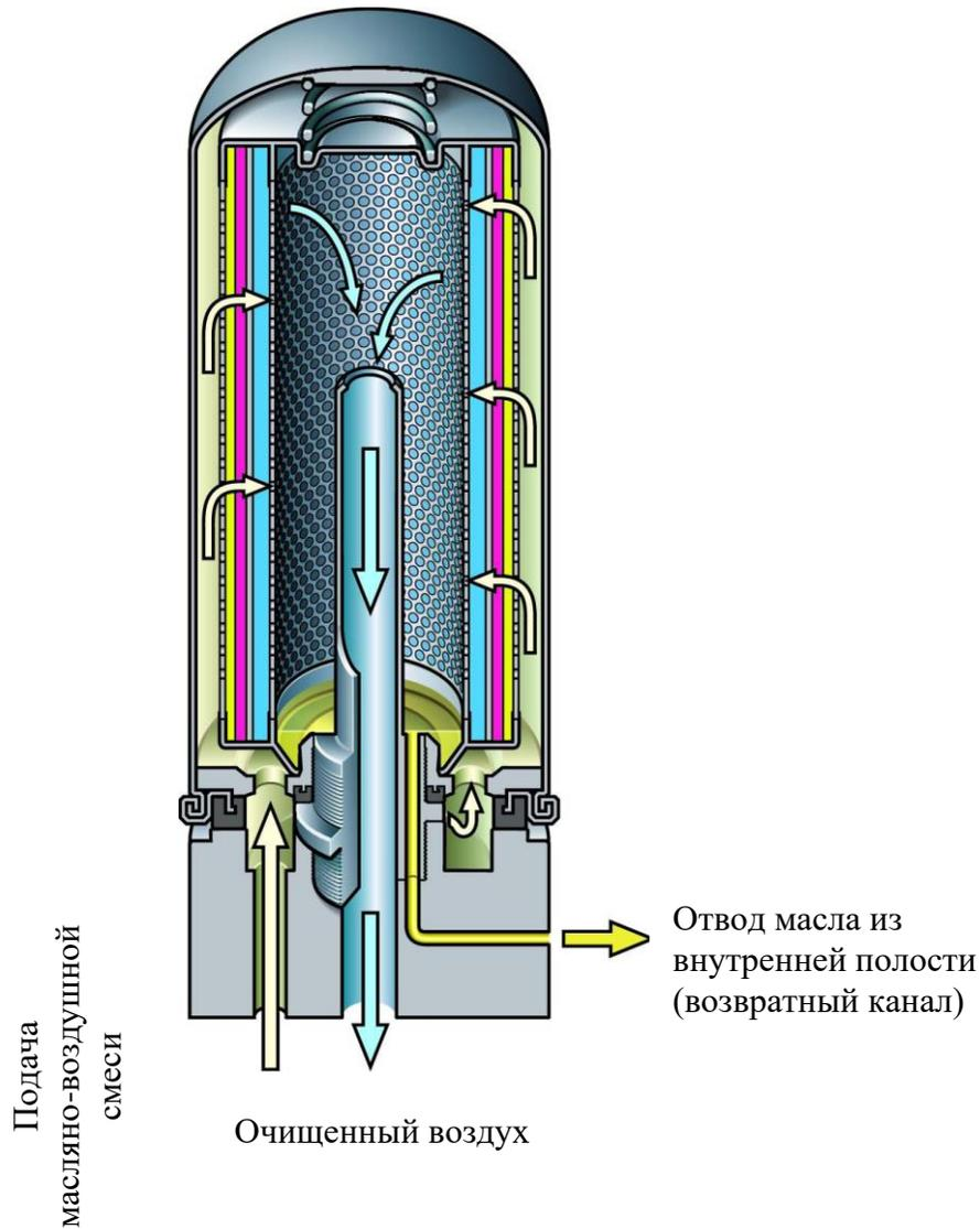
Рисунок 7. Картридж сепаратора.
