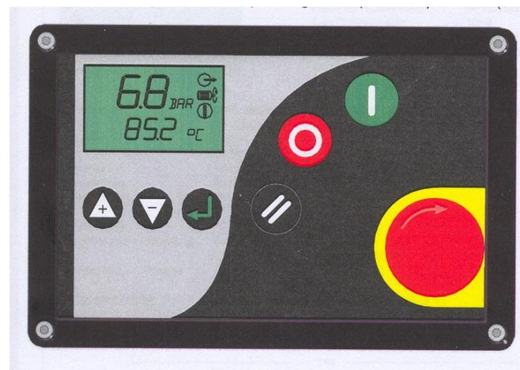
Контроллер (Блок управления компрессом) предназначен для автоматического управления работой установки и её отключения при возникновении аварийных значений контролируемых параметров.
