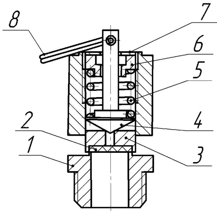
**Рисунок 11. Клапан предохранительный установок**
