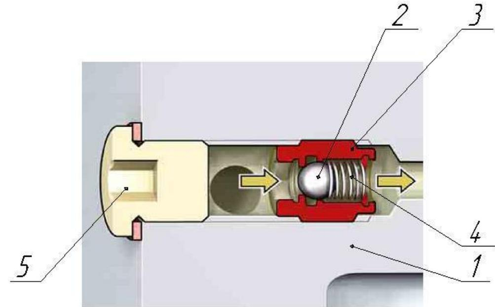
Рисунок 16. Клапан обратный возвратного маслостока.
