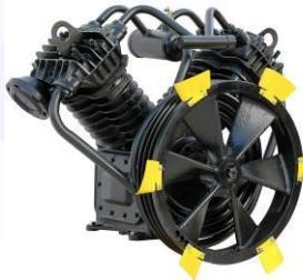
Массивная и надежная **поршневая компрессорная головка C416M** производится Бежецким заводом "ACO", является основным узлом компрессора и предназначена для сжатия воздушной смеси. Сжатие воздуха происходит в двухступенчатом режиме при прохождении по цилиндрам высокого и низкого давления. При достижении заданного давления сжатый воздух поступает в ресивер.
