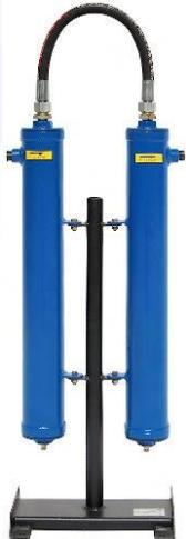
Фильтрационный модуль предназначен для тонкой очистки сжатого воздуха и различных газов от аэрозолей, масла и влаги, а также от твердых частиц. Используется в пневмосистемах, пневмоприводе устройств и инструмента.
