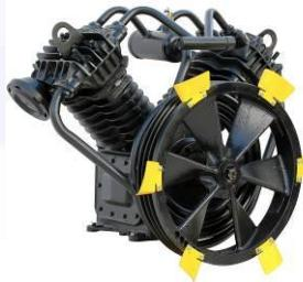
Массивная и надежная **поршневая компрессорная головка C416M** производится Бежецким заводом "АСО", является основным узлом компрессора и предназначена для сжатия воздушной смеси. Сжатие воздуха происходит в двухступенчатом режиме при прохождении по цилиндрам высокого и низкого давления. При достижении заданного давления сжатый воздух поступает в ресивер.
