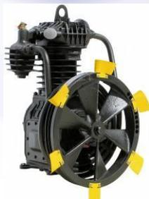
Массивная и надежная **поршневая компрессорная головка С415М** производится Бежецким заводом "АСО", является основным узлом компрессора и предназначена для сжатия воздушной смеси. Сжатие воздуха происходит в двухступенчатом режиме при прохождении по цилиндру высокого и низкого давления. При достижении заданного давления сжатый воздух поступает в ресивер.
