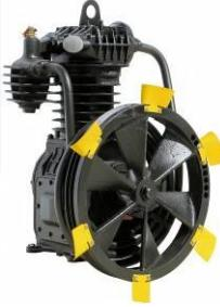
Массивная и надежная **поршневая компрессорная головка C415M** производится Бежецким заводом "АСО", является основным узлом компрессора и предназначена для сжатия воздушной смеси. Сжатие воздуха происходит в двухступенчатом режиме при прохождении по цилинду высокого и низкого давления. При достижении заданного давления сжатый воздух поступает в ресивер.
