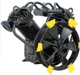
Массивная и надежная **поршневая компрессорная головка С416М** производится Бежецким заводом "АСО", является основным узлом компрессора и предназначена для сжатия воздушной смеси. Сжатие воздуха происходит в двухступенчатом режиме при прохождении по цилиндрам высокого и низкого давления. При достижении заданного давления сжатый воздух поступает в ресивер.
