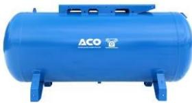
Каждый ресивер в процессе изготовления проходит полный комплекс обязательных испытаний и контроль качества, что гарантирует полную безопасность при эксплуатации. Продольный шов и кольцевые сварные соединения подвергаются контролю методом ультразвуковой дефектоскопии. Проводятся обязательные гидравлические испытания на прочность, и пневматические испытания на герметичность.
