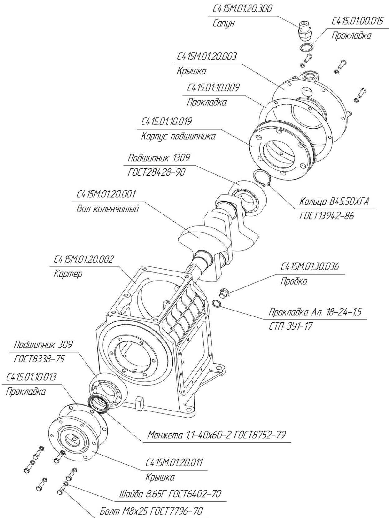
**Устройство компрессорной головки С415М
