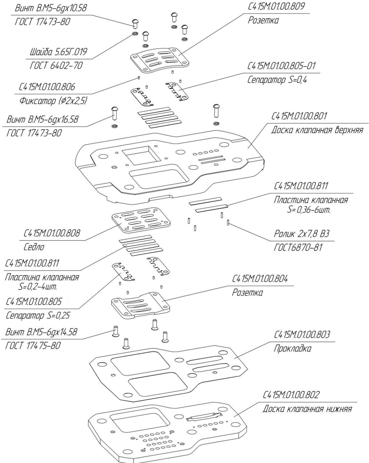
**Устройство компрессорной головки С415М**
