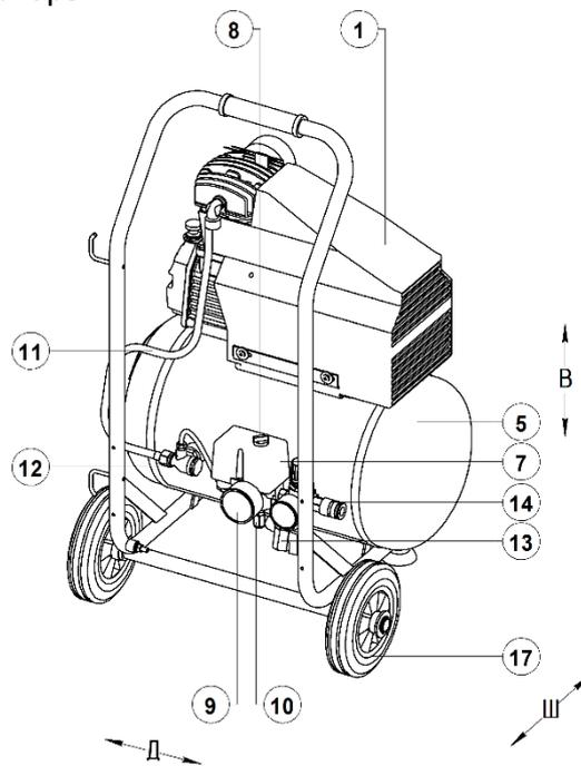
Рисунок 5 - Общий вид компрессора СБ4/С-20.Ј1047В, СБ4/С-20.Ј1048В
