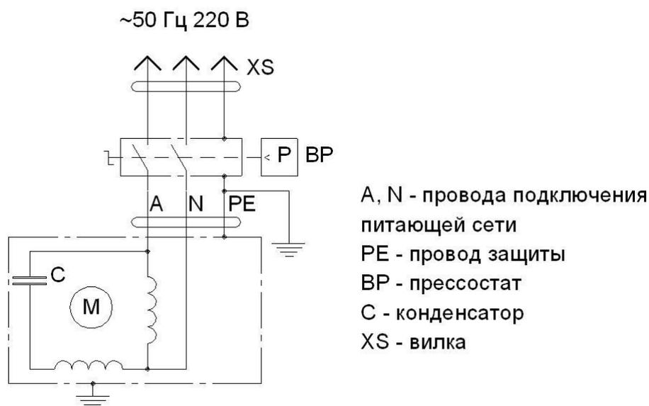
Рисунок А.1 - Схема электрическая принципиальная компрессоров
