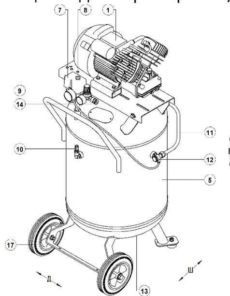
Рисунок 10 - Общий вид компрессора СБ4/С-100.Ј2047ВВ
