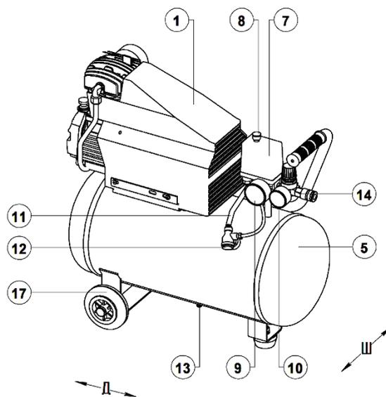
Рисунок 6 - Общий вид компрессора СБ4/С-24.Ј1047В, СБ4/С-24.Ј1048В
