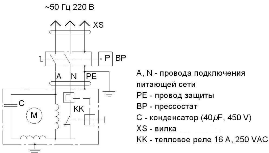
Рисунок А.2 - Схема электрическая принципиальная компрессоров
