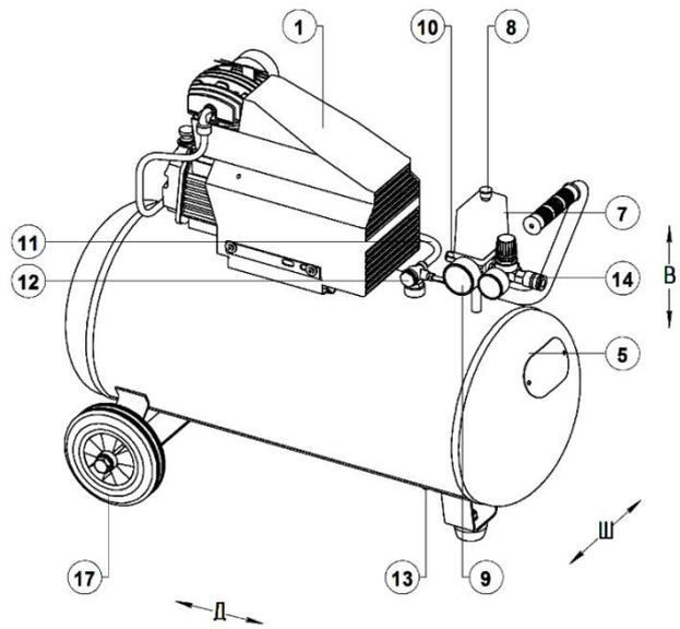
Рисунок 7 - Общий вид компрессора СБ4/С-50.Ј1047В, СБ4/С-50.Ј1048В
