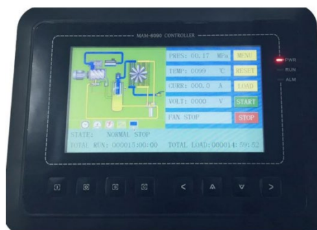
Рисунок В.1 Дисплей контроллера
